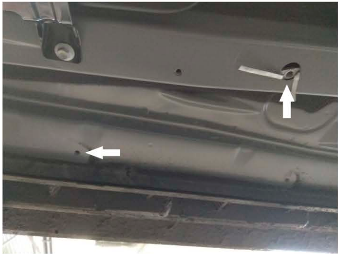
Рис. 2 - Места крепления среднего кронштейна
