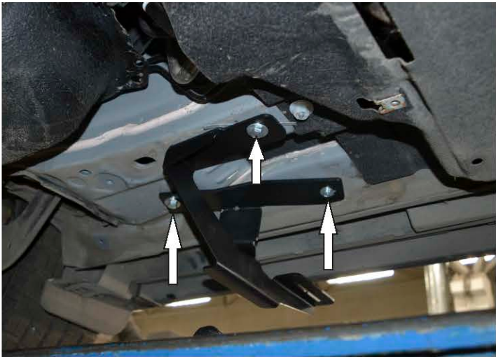
Рис. 6 - Установка заднего кронштейна
