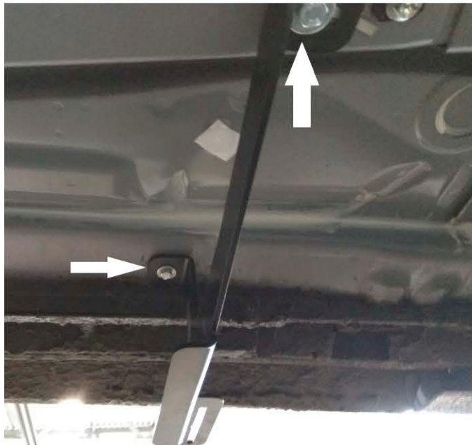
Рис. 4 - Установка переднего кронштейна
