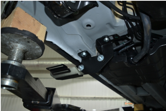
Рис. 4 - Установка задних кронштейнов
