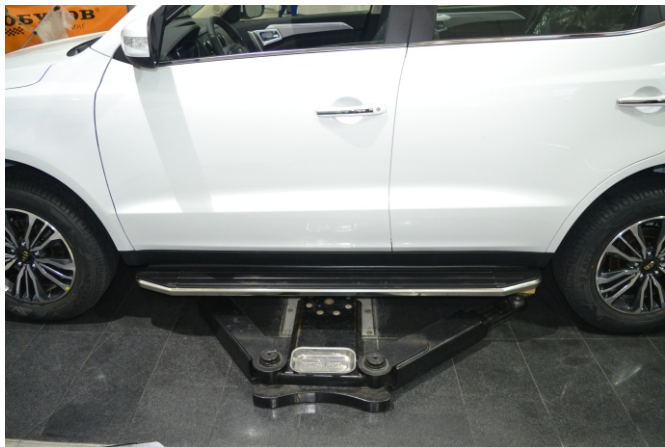
Рис. 5 - Вид установленного порога
