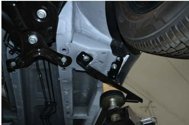
Рис. 3 - Установка передних кронштейнов
