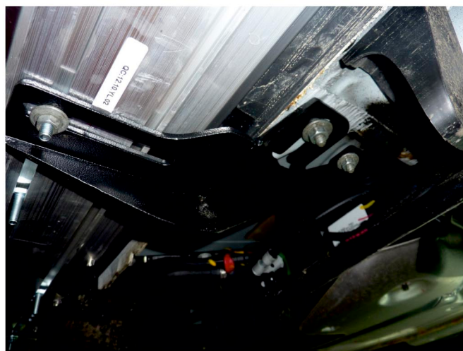
Рис. 6 - Установка заднего кронштейна
